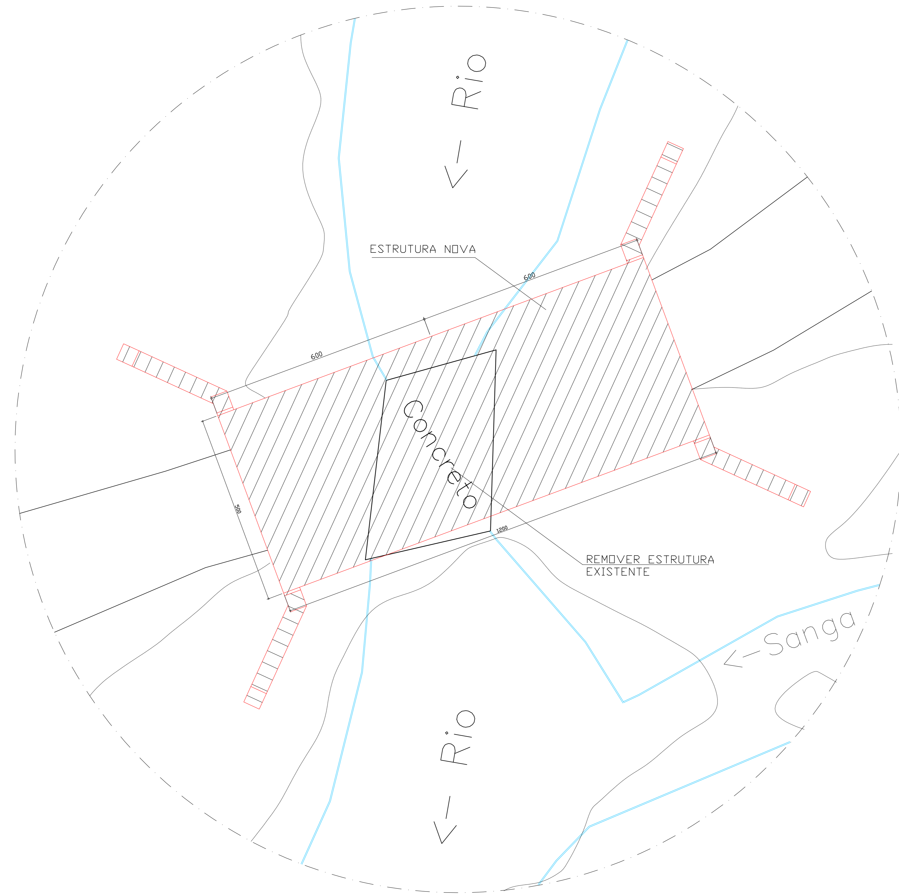
Detalhe: Localização da Ponte Escala: 1:100
