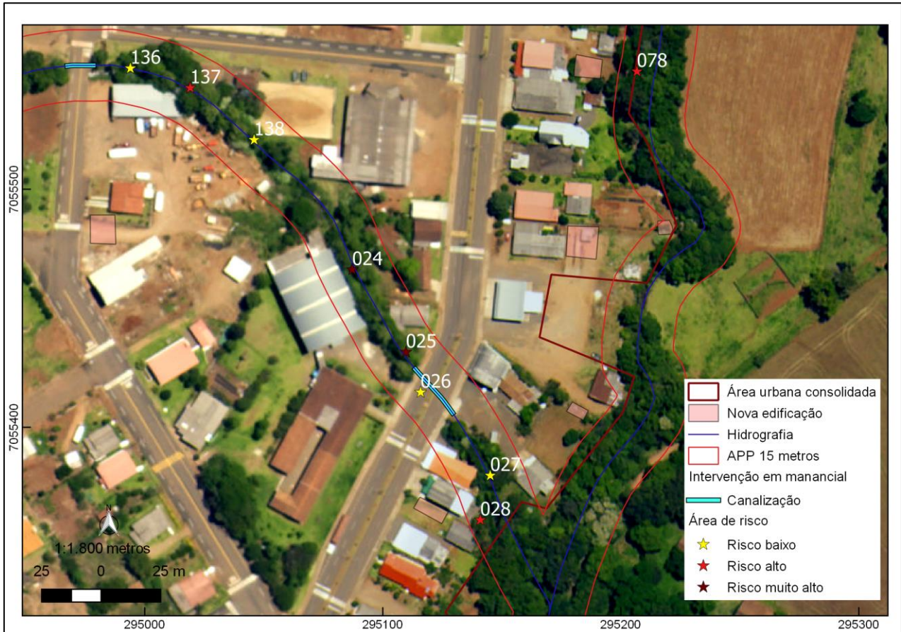
Figura 66. Área de risco identificadas próximas ao Colégio Estadual, com ênfase para a área de inundação e alagamento (Pontos 24 e 25) que afeta a Escola Estadual Urbana Emília Boos Laus Schmidt em Saltinho, Santa Catarina.
